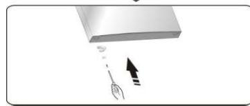
10. Cambiare le coperture dei fori sulla piastra di copertura da sinistra a destra (come mostrato nella figura sottostante).
